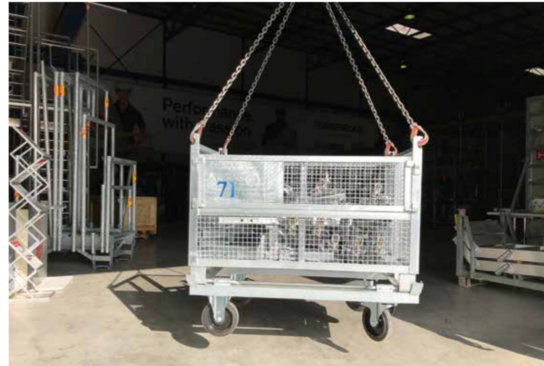
► Die Gitterbox ermöglicht das Verwahren von Verbindungsmitteln, Ankermuttern etc. Sie kann am Laufwagen befestigt und mit dem Kran versetzt werden. Die einfache Handhabung spart erheblich Kranzeit ein – eine klare Verbesserung für Lager und Logistik.
