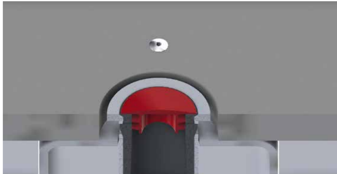
► Querschnitt der Schalhaut mit Ankeröffnung und Dichtkonus
