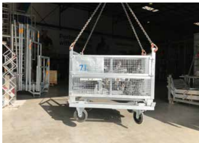
► Die Gitterbox ermöglicht das Verwahren von Verbindungsmitteln, Ankermuttern etc. Sie kann am Laufwagen befestigt und mit dem Kran versetzt werden. Die einfache Handhabung spart erheblich Kranzeit ein – eine klare Verbesserung für Lager und Logistik.
