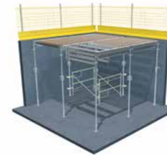
► Rundum gesichert durch einfache Montage der Absturz-sicherung
